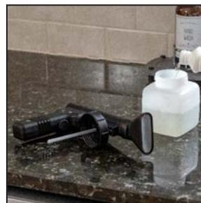
**1** Prepare o pulverizador portátil. Desaperte o tanque e encha-o até  $\frac{3}{4}$  com líquido não-inflamável.
