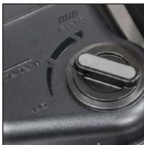
**6** Rode a válvula de controlo de espuma no sentido dos ponteiros do relógio para a posição de "PAVIMENTO RÍGIDO". Coloque o Tech Drive® Power Assist na posição neutra "N". Ligue o Kirby®. À medida que a unidade avança e retrocede, a solução de limpeza é libertada e o esfregão rotativo esfrega o chão. Não deixe cair grandes quantidades de líquido no chão.
