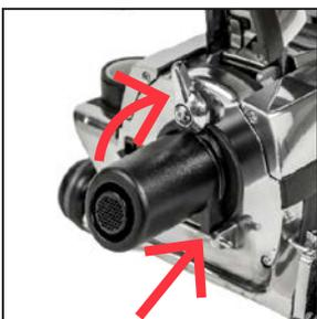
**1** Remova o bocal grande. Consulte a página 21. Coloque os ganchos na parte de trás da guarda de entrada de ar sobre a barra de fixação na parte da frente da unidade. Incline a guarda de entrada de ar contra a unidade e rode o travão de acessório no sentido dos ponteiros do relógio para a fixar no lugar.
