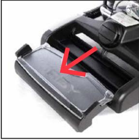
**5** Se necessário, esvazie a bandeja de desperdício enquanto faz a limpeza. Verifique os indicadores transparentes na extremidade da tampa da bandeja de desperdício. Quando o líquido começar a encher a área abaixo dos indicadores, é altura de esvaziar a bandeja de desperdício.
