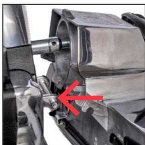
**3** Coloque os dois ganchos na parte de trás do bocal grande na barra de fixação na parte da frente da unidade. Incline até ficar nivelado com a face da unidade, em seguida rode o Travão de Acessório para o bloquear no devido lugar.
