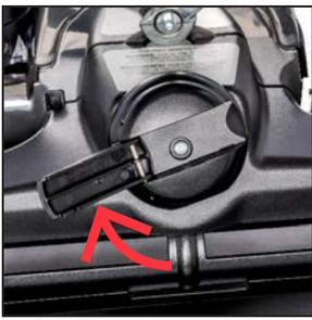
**12** Utilice el mango del mecanismo de elevación de la correa del cabezal de lavado multisuperficie para girarlo hacia la derecha hasta que se alineen las flechas verdes. Baje la cubierta de la luz frontal.
