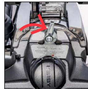
11 Incline hacia arriba el sistema de lavado multisuperficie hasta enrasarlo con la superficie de la unidad y gire el cierre auxiliar hacia la derecha para fijarlo en su sitio.
