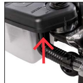
**4** Conecte la manguera acodada a la parte inferior del depósito de lavado.
