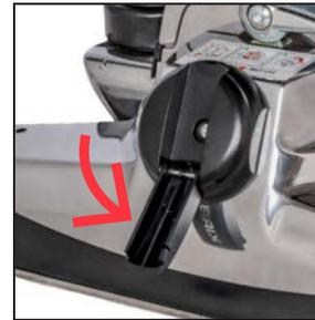
**2** Gire el mecanismo de elevación de la correa hacia la izquierda hasta que las flechas rojas se alineen en la posición de «BELT OFF» (correa suelta).
