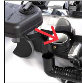
**17** Con cuidado de no derramar líquido sobre la unidad o el suelo, coloque la abertura en la parte inferior del depósito de lavado, por encima de la salida de aire.
