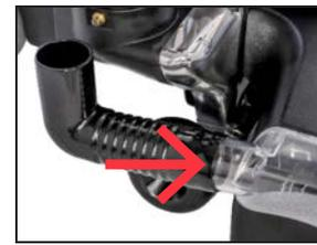
**16** Conecte con firmeza la manguera acodada al cabezal de lavado multisuperficie.
