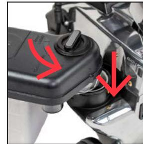
**2** Fije el depósito de lavado vacío a la salida de aire. No hace falta acoplar la manguera acodada.
