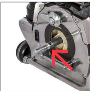
Evite que se acumulen pelusas, cabello o residuos en el eje del motor.
