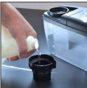
**15** El depósito de lavado debe llenarse o vaciarse en un fregadero. Desenrosque el tapón grande de la parte superior del depósito de lavado. Coloque la válvula de control del jabón en posición «OFF» (cerrada). Llene el depósito con agua tibia (no caliente) de acuerdo con el siguiente cuadro.
